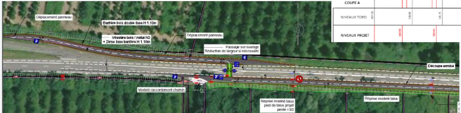
Passage au sud le long de la RD avec modèle pour réalisation de la voie de 3,00 m + barrières de protection + accotement. Le passage sur les ponts est assez large pour passer avec la RD sans création de passerelles.
